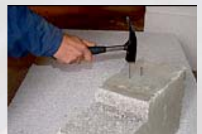
Les clous reposent bien dans les blocs de béton mousse
